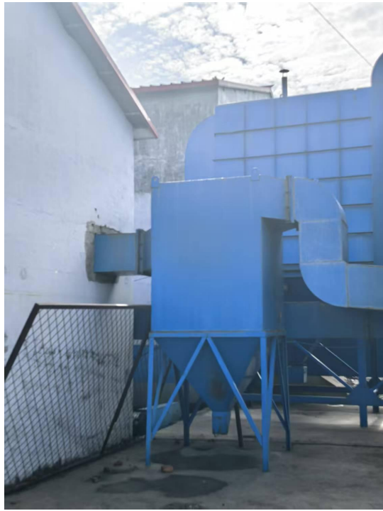
5t/h热风炉陶瓷多管除尘器
